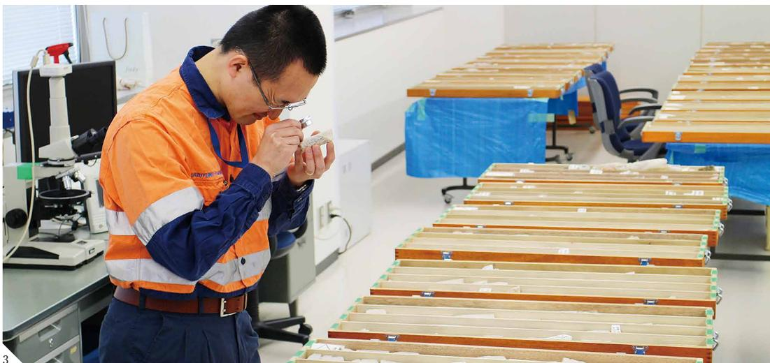
1.職場の同僚達と。/ 2.アブダビにある出向先の現地操業会社にて。夏場の暑さは過酷です。/ 3.地下深部より回収された油田の岩石コア試料の観察。
