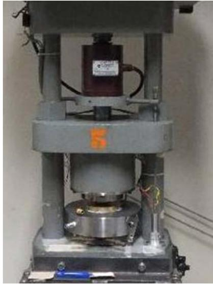
図1: Griggs 型固体圧変形試験機.
