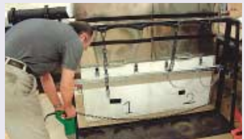
図1：独自に製作したボンベ立てを固定しているところ。
