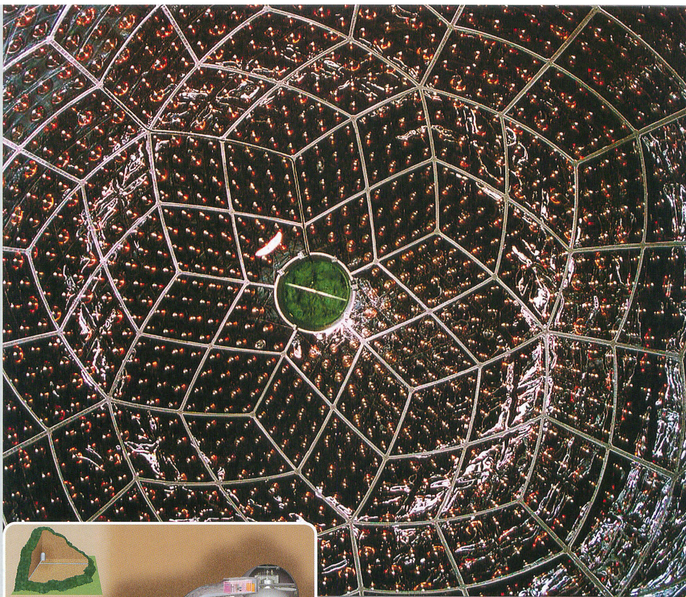
カムランドの心臓部であるタンクの内壁に敷き詰められた光電子増倍管
