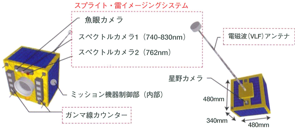
図1. SPRITE-SATの外観。衛星底面（地球側）に3台の高感度カメラとガンマ線カウンターが取り付けられている。
