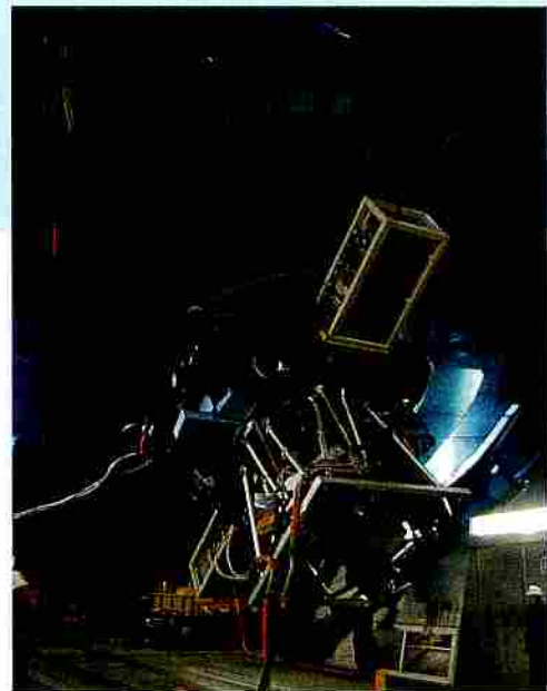
すばる望遠鏡に搭載された多天体分光撮像装置モアックス
