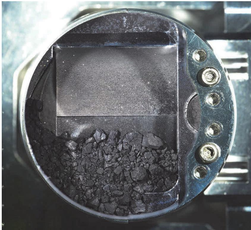
「はやぶさ2」サンプルキャッチャ内の粒子（©JAXA）。第一回目のタッチダウン時に採取されたものと考えられる。キャッチャ円筒の直径は48mm。
