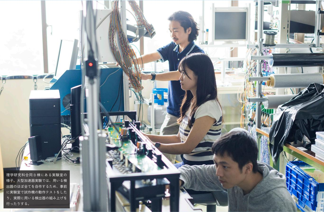
理学研究科合同B棟にある実験室の様子。大型加速器実験では、用いる検出器のほぼ全てを自作するため、事前に実験室で試作機の動作テストをしたり、実際に用いる検出器の組み上げを行ったりする。
