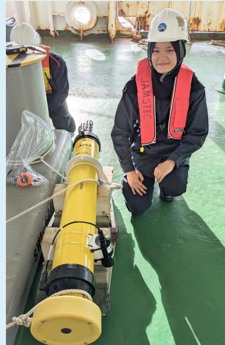
水温、塩分、圧力に加え、クロロフィル濃度や光なども測定可能な BGC-Argo フロート。海の中を浮き沈みしつつ、自動で測定を行い、衛星経由でデータを届けてくれる。
