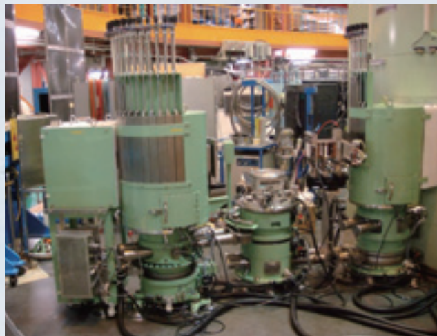
写真2 JRR-3に設置されている中性子散乱装置TOPAN。右手から中性子ビームを取り出し、中央付近のテーブル上の試料で散乱された中性子を、左端の検出器で計測します。
