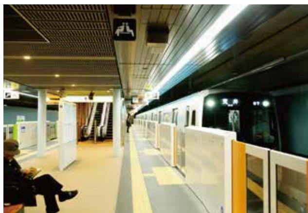
○急勾配や急カーブに強い車輪式リニアモーター車両。南北線車両と比べて外形は3割ほど小さくなっていますが、内装は車内が広く見えるように工夫されています。
