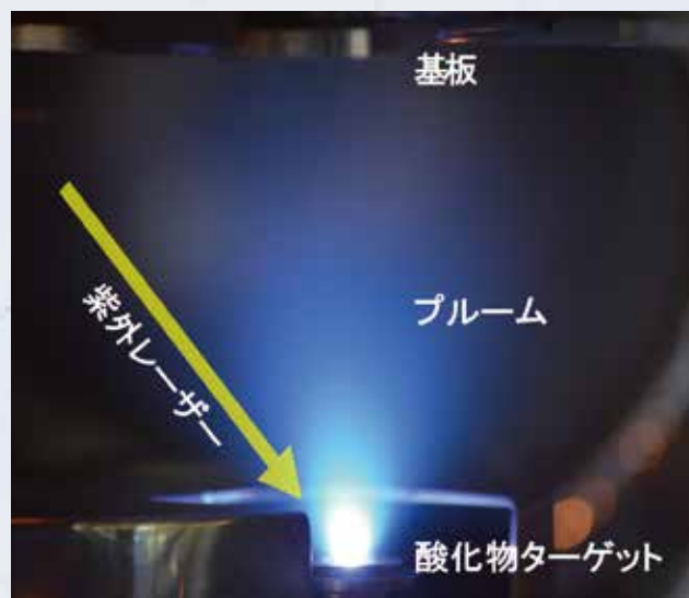
(図1) 紫外レーザー照射で酸化物ターゲットが蒸発する様子
