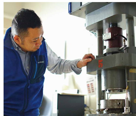
左：研究員のメンバー 右：Griggs 型の岩石変形試験機
