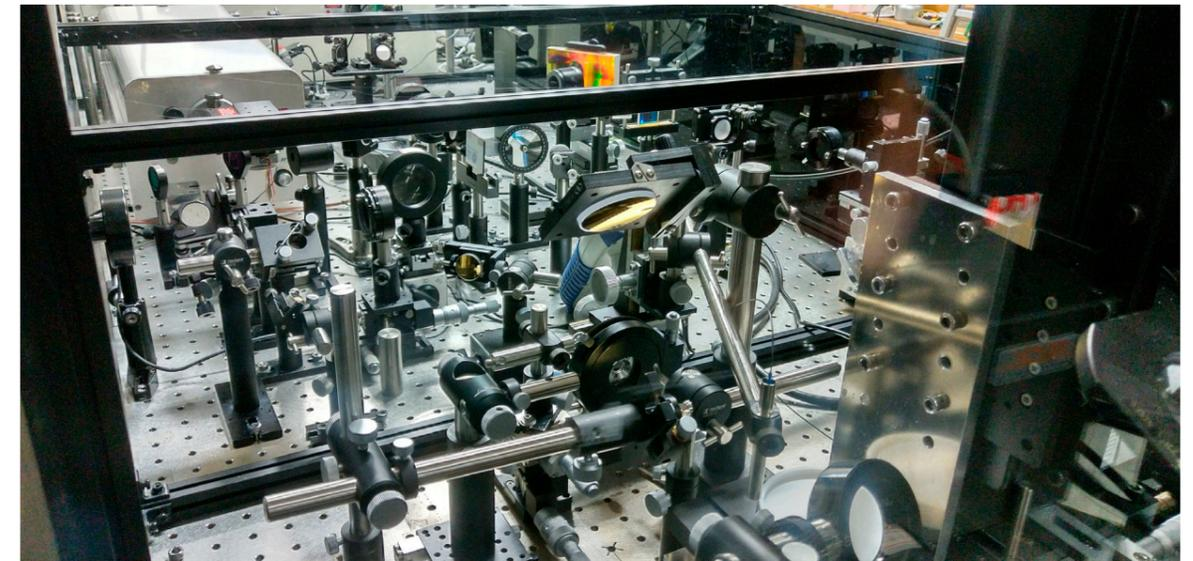
図1 超短パルスレーザーを用いた和周波発生分光装置
