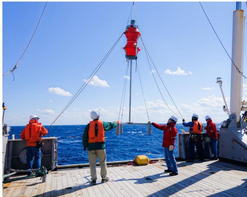
写真2 海底間音響測距装置。海溝を挟んだ2点間の距離計測により海陸のプレート間の相対運動を直接観測することができる。
