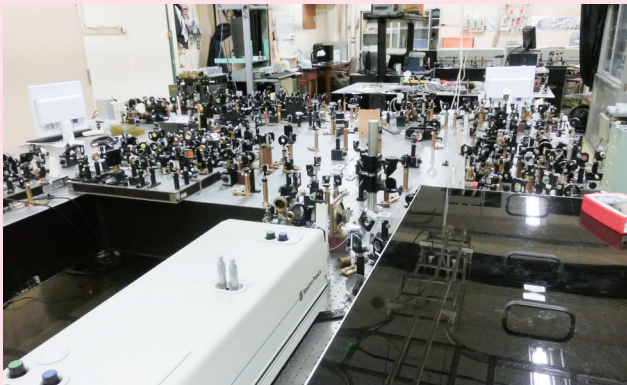
フェムト秒分光装置。レーザーの先に200を超えるレンズやミラーが所狭しと並んでいる。
