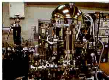
図1 世界最高の分解能を達成する超高分解能光電子分光装置
