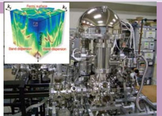
超高分解能光電子分光装置
