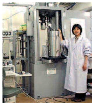
ガス圧式高温高压岩石変形試験機は、地下8km相当の場所の高温、高压を実現し、岩石破壊、摩擦すべり流動変形、水・岩石相互作用などを実施することができる
