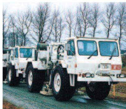
反射法地震探査で東西10km、地下1km程度の範囲の地下構造を探索する
