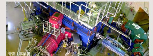
電子リナックや電子シンクロトン(写真左)で得られる高エネルギー電子光ビーム\*)や大型サイクロトン(写真右)で得られるイオンビームを学内のみならず国内外の共同利用に提供し、クォークから原子・分子に至る広い自然階層の「物質の構造と性質」を研究しています。特に電子散乱実験、原子核反応研究、放射性同位元素を利用する応用研究、干渉性が高いコヒーレント放射光の開発研究および粒子線治療などのための技術開発が進展しています。\*)電子ビームから作られる光子、陽電子などの総称
