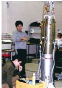
オーロラめがけて打ち上げられたロケット観測装置(先端)
