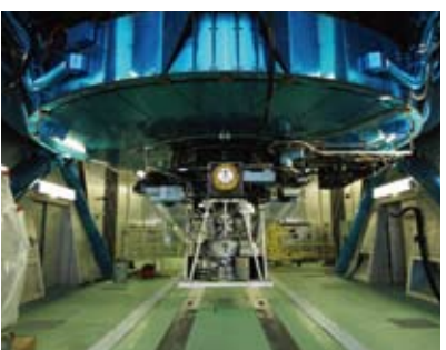
すばる望遠鏡8m主鏡部分とカセグレン焦点部分
