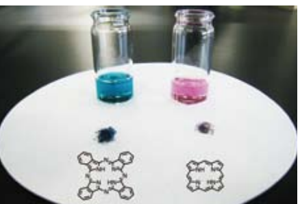
ポルフィリン(右)とフタロシアニン(左)の構造(下段)と固体及び溶液状態の色(中段および上段)
