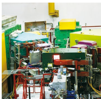
東北大学が日本で製作し米国ジェファソン研究所に設置した高分解能K中間子検出器（HKS）と高分解能散乱電子検出器（HES）、電荷分離電磁石（SPL）。東北大のスクールカラーの緑に塗ったのですが、電磁石毎に微妙に色合いが変わってしまいました。
